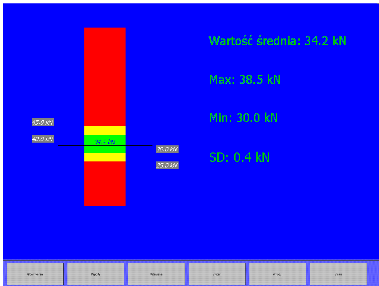
Rys. Wykres słupkowy z parametrami statystycznymi siły zgniotu na wybranym stemplu
